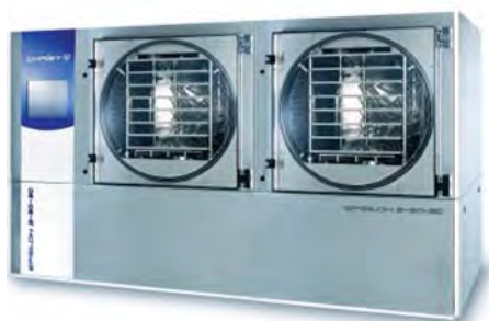
Рис. 3. Сушарка EPSILON 2-90/90 з двома відділеннями загальною потужністю 180 кг льоду/цикл в конденсаторі (загальна поверхня 22,6 м 2 ; призначена для оброблення кисломолочної продукції)
