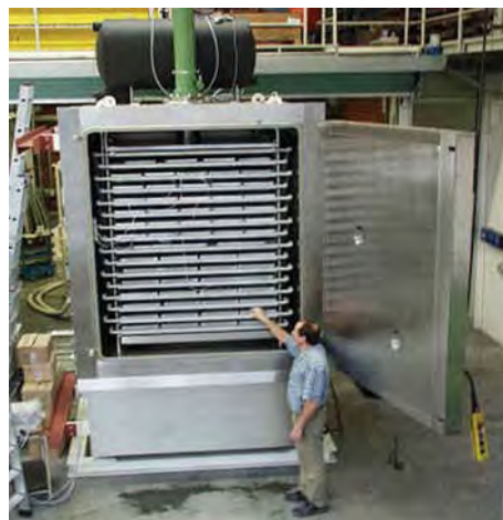
Рис. 5. Сушарка з площею 40 м 2 і потужністю за льодом 500 кг/цикл
