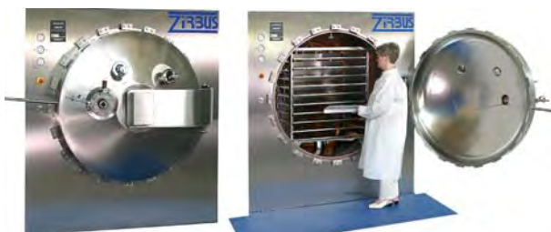
Рис. 16. Sublimator 150-6: площа полиць 6,5 м 2 , сGMP, СІР-SІР, продуктивність 150 кг/добу
