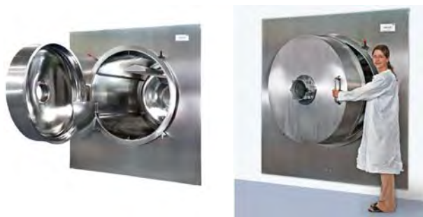
Рис. 15. Rotation Freeze Dryers для сушіння харчових і фармацевтичних продуктів продуктивністю до 800 кг/добу
