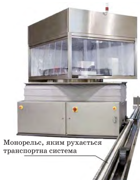
Рис. 7. Ліофільна сушарка PennTech-Autoloaders, що може обертатись
