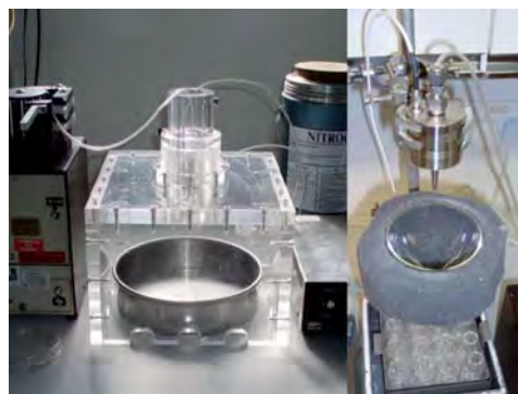
Рис. 14. Лабораторне розпилювально-сублімаційне сушіння у парі над рідким азотом
