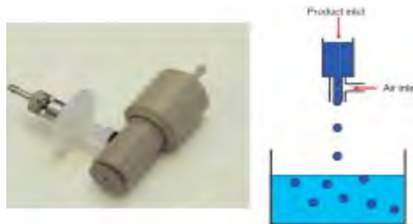
Рис. 4. Крапельний метод за допомогою коаксіального повітря (з дозволу Chralampopoulos D., Rastall R.A., 2009)
