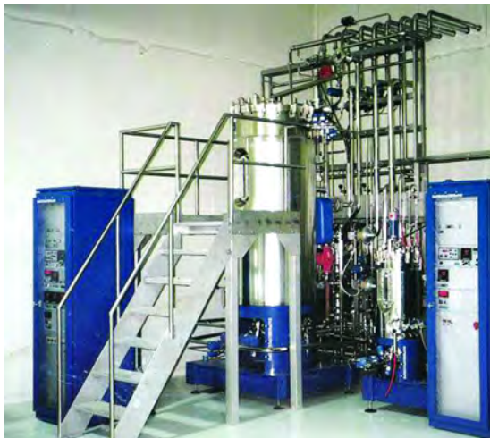
Рис. 5. Багатоцільова пілотна установка фірми Bioengineering AG для GMP-ферментації в чистій кімнаті (варіант 2)
