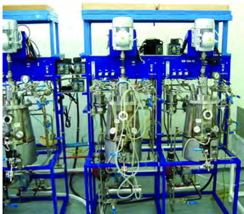
Рис. 13. Пілотний ферментер об'ємом 10 л НДІ ЗАТ «Биотехника»
