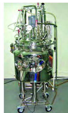
Рис. 22. Газовихровий біореактор об'ємом 300 л
