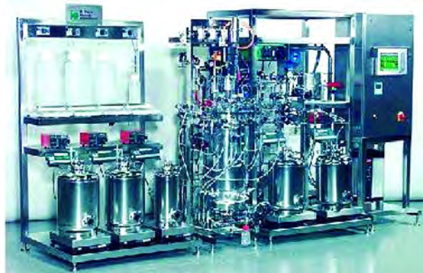
Рис. 10. Інтегрована установка BIOSTAT® C X-FLOW у складі ферментаційної системи для одержання рекомбінантного протеїну під час культивування Pichia pastoris
