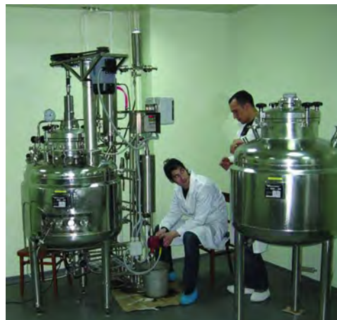
Рис. 14. Пілотний ферментер об'ємом 100 л НДІ ЗАТ «Биотехника»
