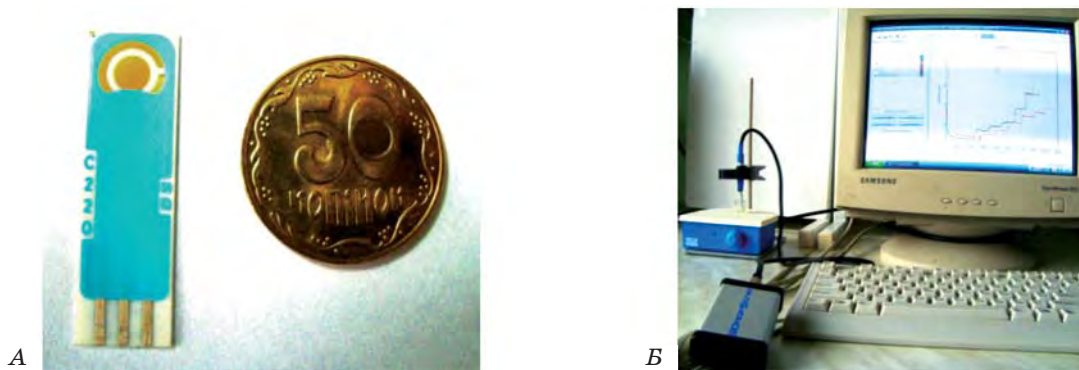
Загальний вигляд триелектродного амперометричного датчика C220AT («DropSens», Іспанія) (А) та експериментальної установки, зібраної на базі приладу \mu Stat 200 («DropSens», Іспанія) (Б)
