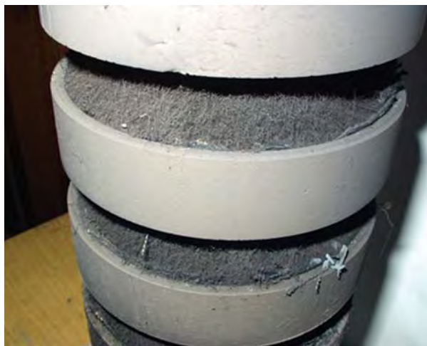
Рис. 2. Внешний вид КОУ, полученных в шахтной печи с ламинарным потоком углеводородного газа
