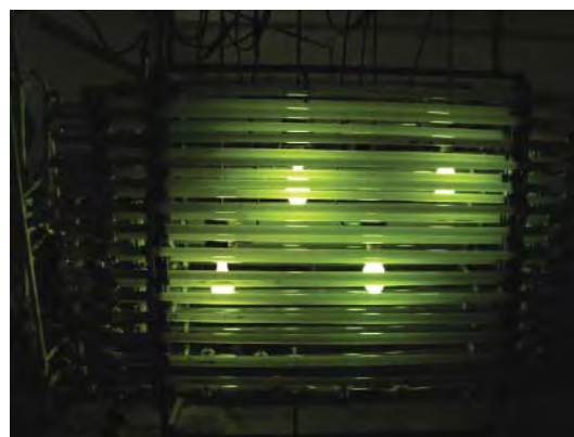
Рис. 8. Трубчастий ФБР зі штучним освітленням потужними натрієвими лампами
