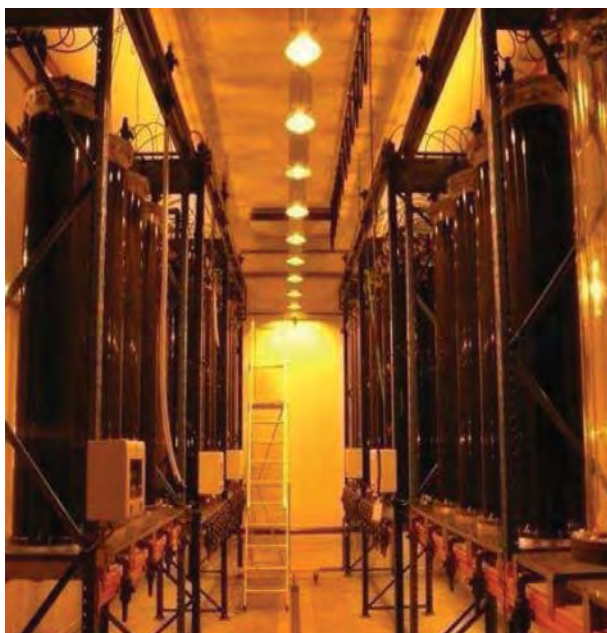
Рис. 19. Установка для одержання водоростевої монокультури за AlgaForce Technology
