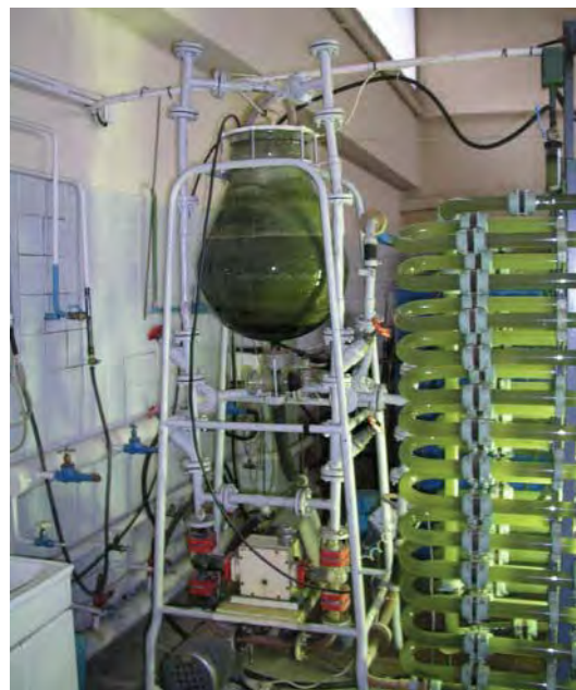
Рис. 7. Перший радянський напівпромисловий трубчастий ФБР для вирощування спіруліни, з якої виробляли «кремлівські таблетки»
