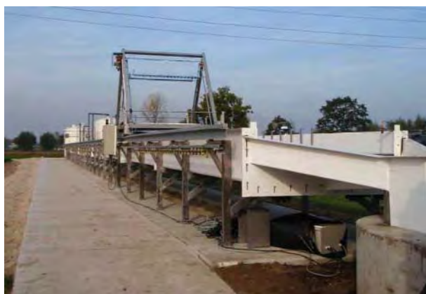
Рис. 20. Установка для вирощування водоростевих полікультур за технологією DiaForce
