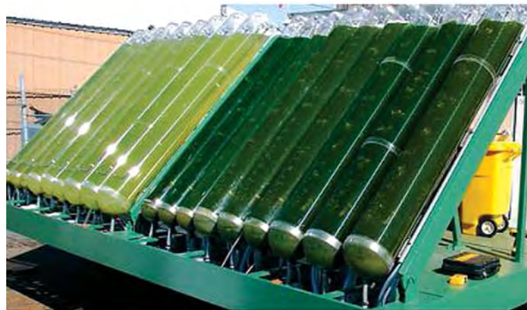
Рис. 12. Пілотно-промисловий ФБР колбового типу періодичної дії (Аризона, США)
