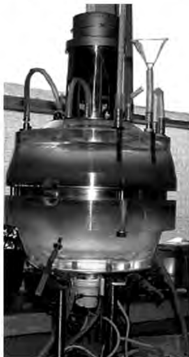
Рис. 4. Принципова схема і зовнішній вигляд ФБР Жаворонкова з гнучкими лопатями об'ємом 2,5 дм 3
