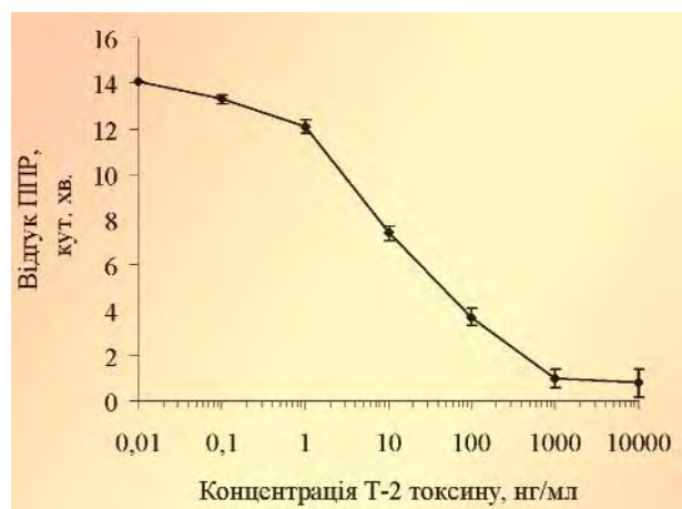
Рис. 5. Визначення Т-2 токсину «конкурентним» методом за допомогою оптичного біосенсора. Вимірювання проводили в ФБР; як контроль використовували сироватки не імунізованих кролів
