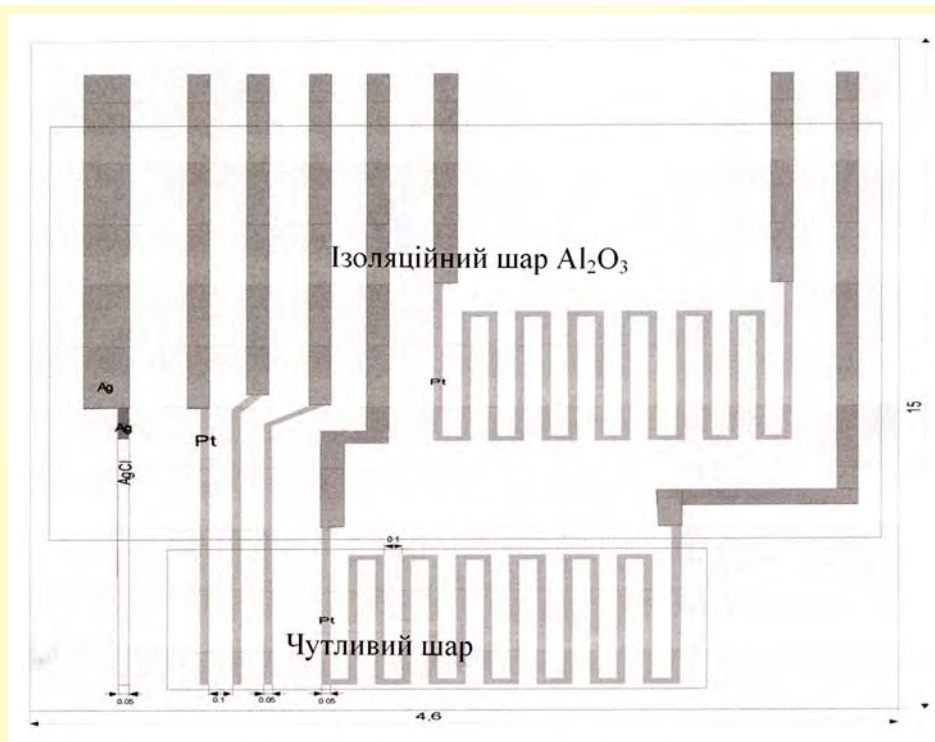
Рис. 4. Топологія елемента тонкошарового інтегрального біосенсора для визначення вмісту глюкози, сахарози та лактози
