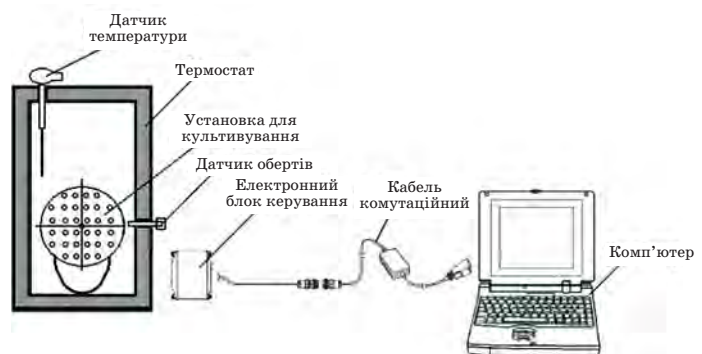
Рис. 1. Схема дослідної ролерної установки для культивування клітин та біосинтезу ІФН
